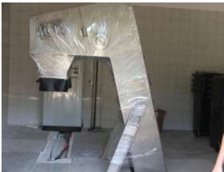
Slika 2.: Ugrađena automatska mehanička rešetka
